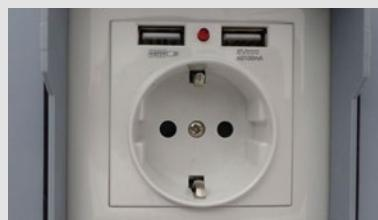
**Hauptmangel:** Die Steckdose weist keinen ausreichenden Schutz gegen elektrischen Schlag auf, das enthaltene Netzteil außerdem keine ausreichende Spannungsfestigkeit. Die Gefahr eines Stromschlages kann nicht sicher ausgeschlossen werden.
