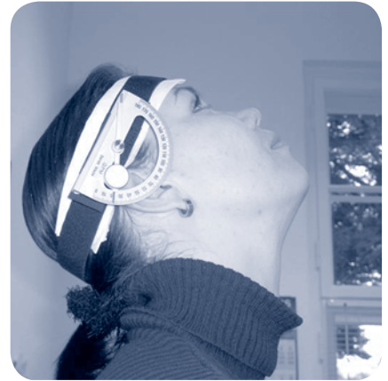
Projekt F1299, Kopfgoniometer Beispiel für eine anthropometrische Messung der Bewegungsräume des Kopfes mit Hilfe eines Kopfgoniometers
