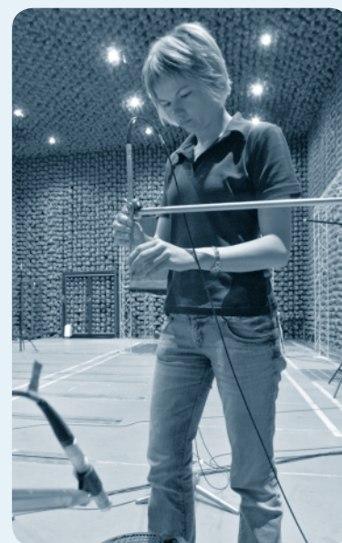
Schallleistungsbestimmung im schallarmen Raum, einem Labor der BAuA
