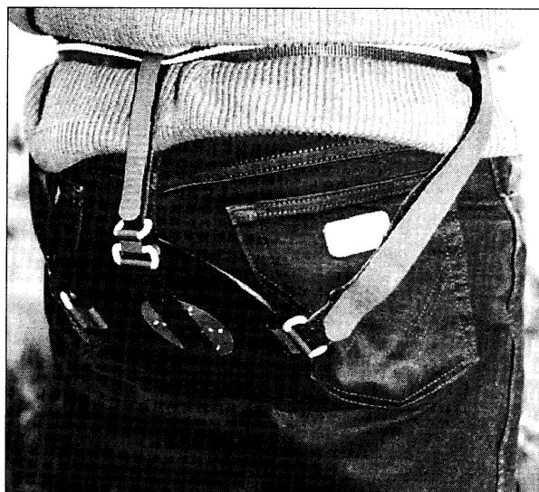
Bild 6: Sitzscheibenbefestigung bei Ganzkörperschwingungsmessungen
