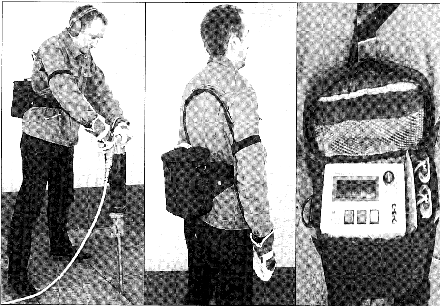
Bild 5: Hand-Arm-Sensor und Schwingungsdosimeter beim Arbeiten mit einem Aufbruchhammer
