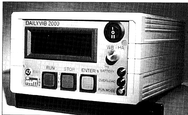
Bild 4: Prototyp des realisierten Schwingungsdosimeters
