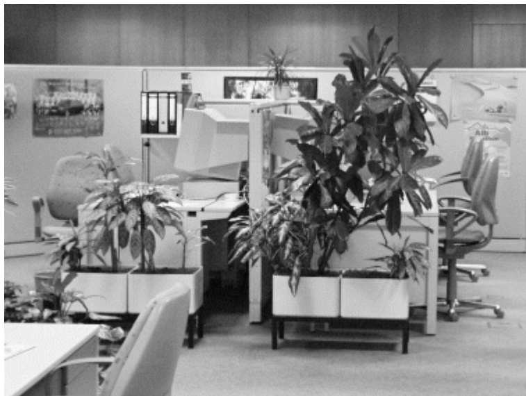
Abbildung Die Tische an diesen Callcenter-Arbeitsplätzen sind ausreichend tief , um einen großen Monitor aufstellen zu können; die notwendige Sehentfernung kann somit eingehalten werden. Der Monitor sollte aber auf der Tischfläche und nicht auf dem Desktopgehäuse aufgestellt werden. Die akustische und räumliche Abschirmung der Arbeitsplätze erfolgt durch schalldämmende Stellwände . Pflanzen , die in großer Anzahl im Büro aufgestellt sind, bieten einen zusätzlichen Sichtschutz, verbessern das Raumklima und tragen zum Wohlbefinden der Mitarbeiter bei.
