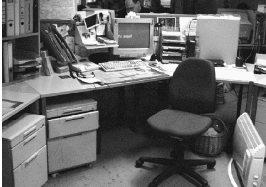
Abbildung Dieser Arbeitsplatz ist nicht ausreichend zu dem gegenüberliegenden Arbeitsplatz abgeschirmt . Die Mitarbeiter in diesem Callcenter stören sich daher gegenseitig durch Kundengespräche. Die Bewegungsfläche an dem Arbeitsplatz überlagert sich mit der Bewegungsfläche anderer, direkt daneben liegender Arbeitsplätze. Es werden sehr viele Unterlagen am Arbeitsplatz gelagert. Hier sollte weiterer Stauraum in Form von Schränken oder Regalen in der Nähe des Arbeitsplatzes zur Verfügung gestellt werden. Im Bewegungsraum des Arbeitsplatzes steht ein Klimagerät - dies weist auf die unzureichenden klimatischen Verhältnisse im Arbeitsraum hin.
