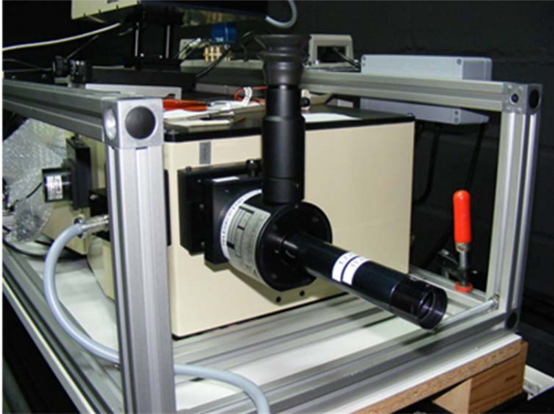
Abb. 4.3 Monochromator mit Strahldichtevorsatz
