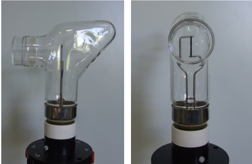
Abb. 5.7 Strahldichtenormal mit Glühfaden
