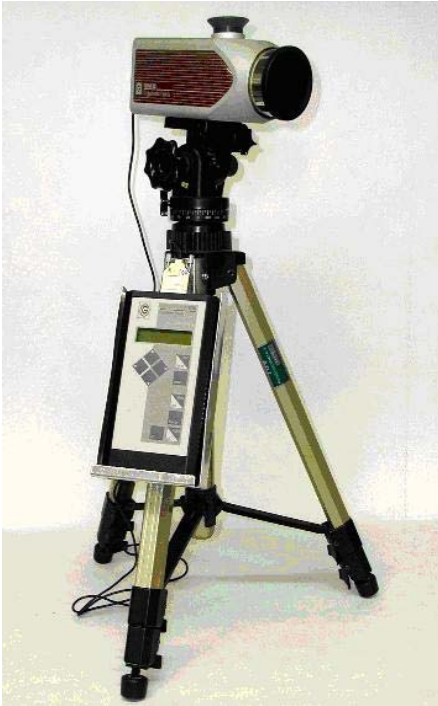
Abb. 4.5 Integralmesssystem für Strahldichte
