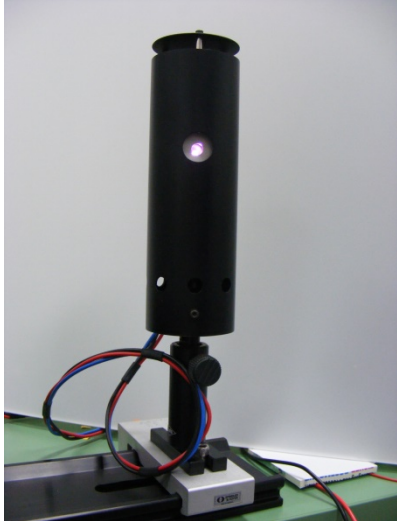
Abb. 5.5 Deuterium-Lampe mit Spektrum
