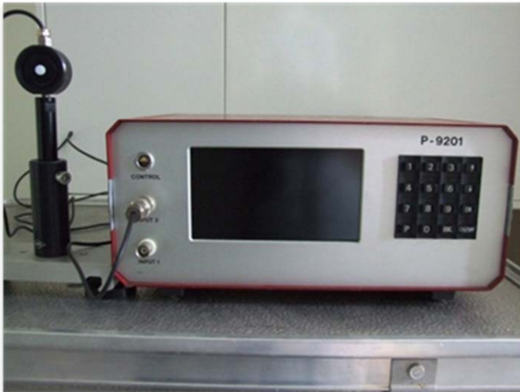
Abb. 4.4 Integral-Messkopf mit Bedien- und Anzeigeeinheit
