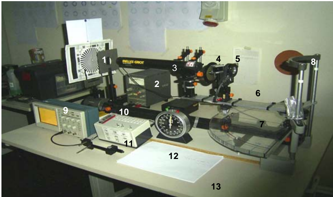
Abb. 4.39 Experimental-Versuchsaufbau zur winkelabhängigen Blending. Komponenten: 1.) Zieleinrichtung („Siemensstern“ und Lochblende); 2.) Netzteil; 3.) Blendlichtquelle (He:Ne-Laser der Klasse 3B mit P_{\max}=10 mW bei \lambda = 632,8 nm, Gaußstrahl ( TEM_{00} ); 4.) Optischer Abschwächer (zur Einstellung der Laserleistung auf Klasse 1); 5.) Shutter (zeitgesteuert); 6.) Ausleger der Länge l = 450 mm (drehbar gelagert auf einer Drehscheibe mit Winkelmaßstab und einer Stützrolle) als Träger für die Blendeinrichtung aus Laser, Abschwächer und Shutter; 7.) Drehteller (halbkreisförmig aus Plexiglas, zum Stützen des Auslegers); 8.) Kinn-/Kopfstütze; 9.) Oszilloskop zur Überprüfung der Zeitsteuerung; 10.) Dreikantschiene; 11.) Zeitsteuerschaltung, bestehend aus einem Zeitrelais; 12.) Stoppuhr (zur Messung der Nachbilddauer); 13.) höhenverstellbarer Tisch
