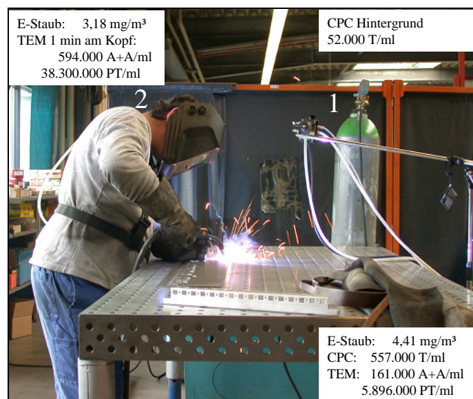
Abb. 3.28 Stationäre (1) und personenbezogene Probenahme (2) am 15.3.06 beim MAG-Schweißen von Edelstahl mit Absaugung nach unten.
