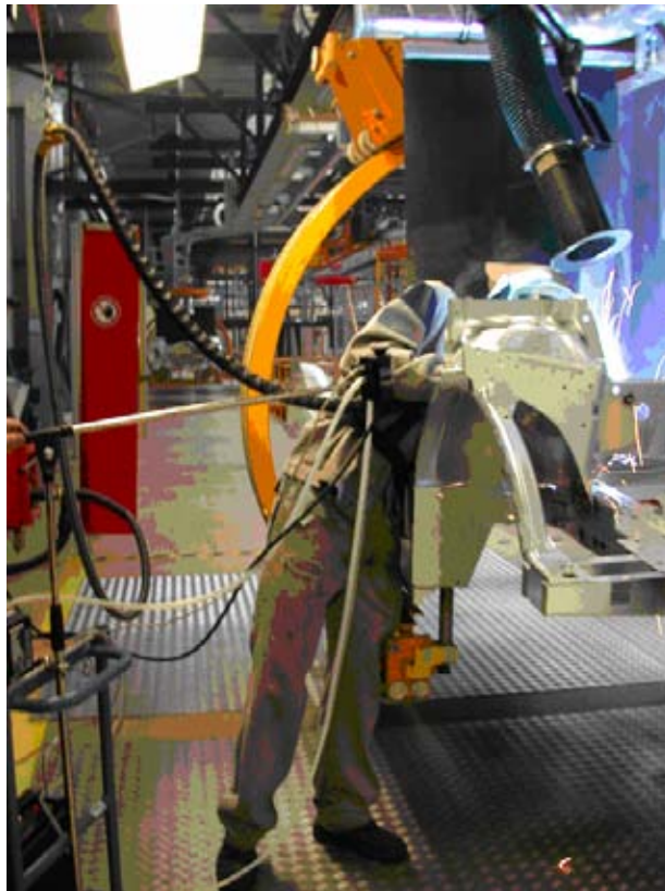
Anh. 3, Abb. 12 Probenahme beim MIG-Schweißen von Bodenblechen.
