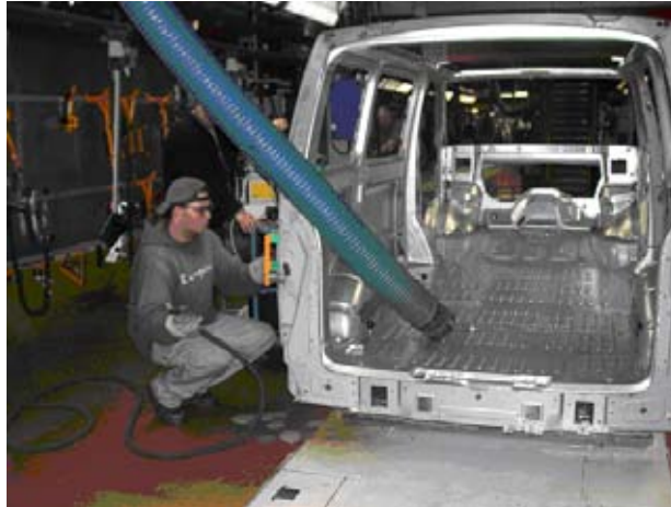
Anh. 3, Abb. 3 Probenahme beim Plasmaschneiden.
