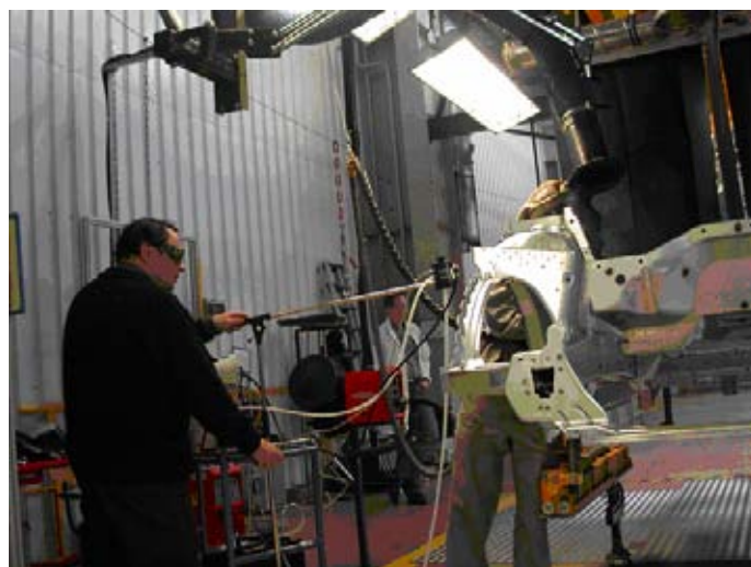
Anh. 3, Abb. 14 Probenahme beim MIG-Schweißen von Bodenblechen.
