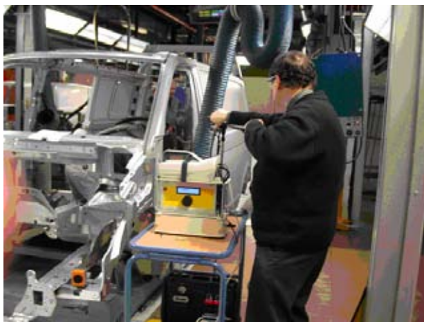
Anh. 3, Abb. 5 MIG-Löten am Nachbararbeitsplatz durch den mit dem Plasmaschneiden beschäftigten Schweißer. Diese während des Plasmaschneidens an einem Nachbararbeitsplatz durchgeführten Arbeiten konnten durch die Probenahme nur unzureichend erfasst werden, vgl. Anh. 3, Abb. 1.
