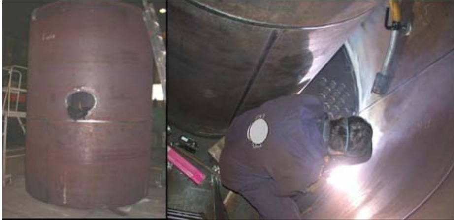
Abb. 1.3 Stationäre Probenahme beim Lichtbogenhand-(LBH)-Schweißen im Inneren eines Kessels.
