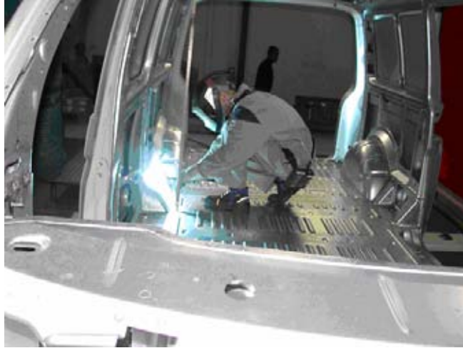
Anh. 3, Abb. 7 MIG-Löten am Radkasten.
