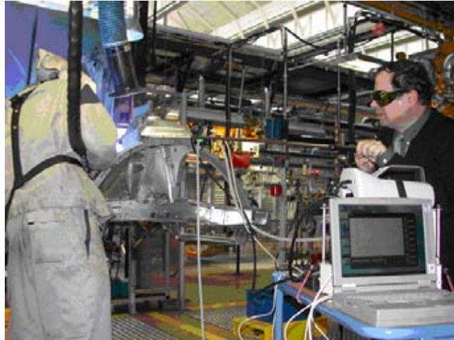
Anh. 3, Abb. 15 Probenahme beim MIG-Schweißen von Bodenblechen.
