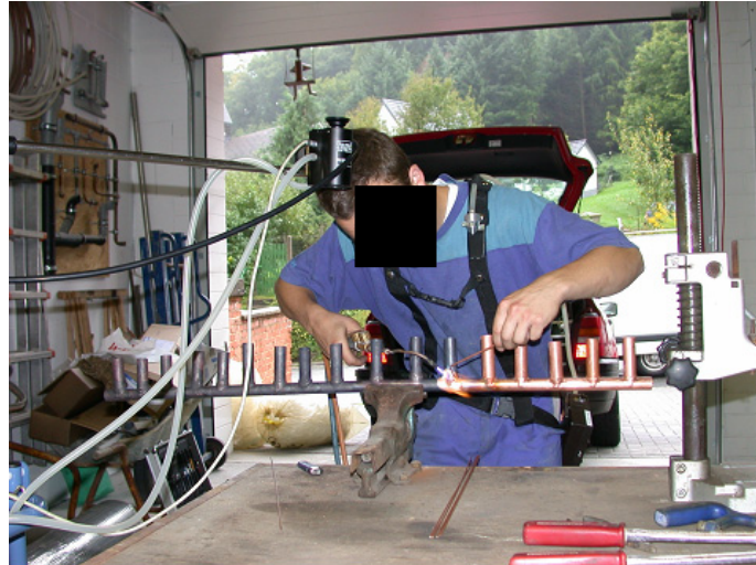
Abb. 3.52 Personenbezogene und stationäre Probenahme beim Hartlöten von Kupferrohren. Aufgrund der Form des Werkstücks verändert sich während der Arbeiten der Abstand zum Ort der Probenahme.
