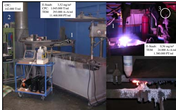
Abb. 3.18 Plasmaschneiden von Aluminium und Edelstahl in einer Schweißwerkstatt am 13.10.05. Links: Plasmaschneidanlage mit Absaugung sowie Messwagen mit den Geräten für die registrierende Messung und dem Gestänge für die halbstationäre Probenahme (1). Oben links ist der Messpunkt des 2. CPC ersichtlich (2). Rechts oben: Halbstationäre (1) und personenbezogene Probenahme (3) während des Plasmaschneidens. Rechts unten: Plasmaelektrode und Werkstück nach dem Schnitt.
