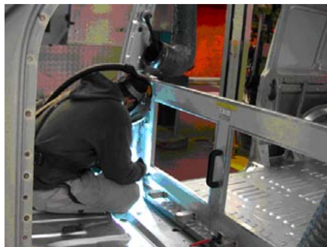
Anh. 3, Abb. 9 MIG-Löten beim Befestigen einer Trennwand. Der Schweißer trägt hierbei einen belüfteten Helm.
