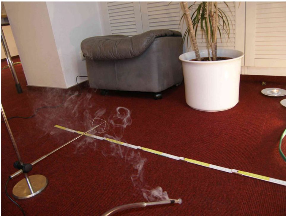
Abb. 5.25 Strömung am Boden vor ausgeschaltetem Heizkörper mit Rauchröhrchen sichtbar gemacht
