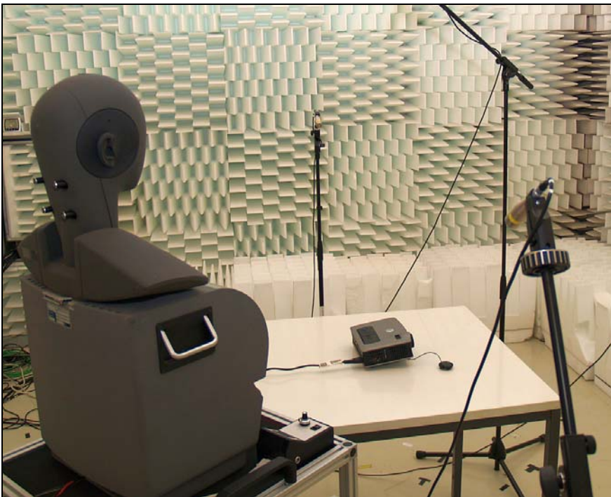
Abb. 6.2 Aufnahmen über binauralen Kunstkopf für den Hörvergleich
