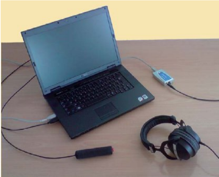
Abb. 8.9 Messausrüstung für den CapaTest , bestehend aus Notebook, Kopfhörer, externer Soundkarte und Signalgeber [60]
