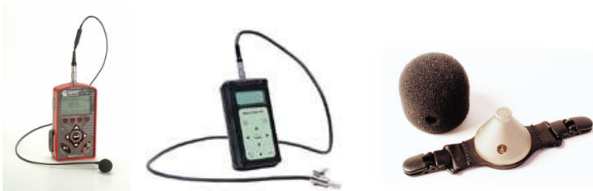
Abb. 5.3 Lärmdosimeter der Klasse 1 und 2 (von links nach rechts: Noise Pro DLX-1 (Klasse 1); Brüel & Kjaer 4444 (Klasse 2); CR 110 A-Aufnehmer (Klasse 2))
