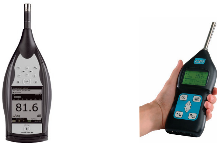
Abb. 5.2 Integrierende Schallpegelmessern der Klasse 1 (von links nach rechts: B&K 2250; CEL 430/1)
