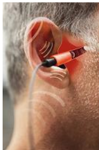
Abb. 8.12 Links: Lärmdosimeter „Quiet Dose“ und rechts: präparierter Gehörschutzstöpsel mit Mikrofon im Ohr eines Trägers (Quelle: Sperian Hearing Protection)
