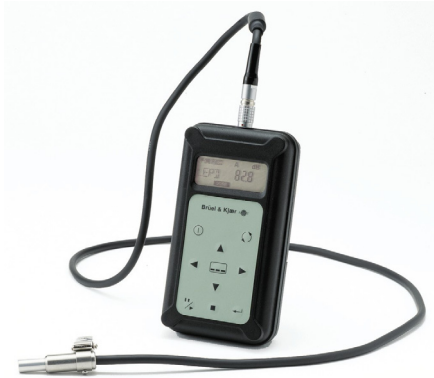
Abb. 7.6 Lärmdosimeter von Brüel & Kjaer, Typ 4436, Gerät der Klasse 2
