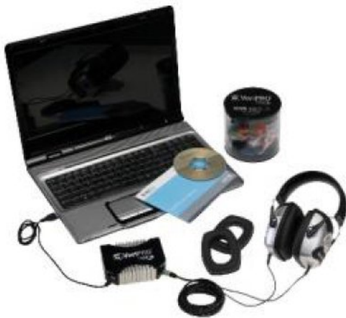
Abb. 8.10 Messausrüstung für das VeriPro -System bestehend aus Notebook mit VeriPro -Software, externer Soundkarte und Kopfhörer [61]
