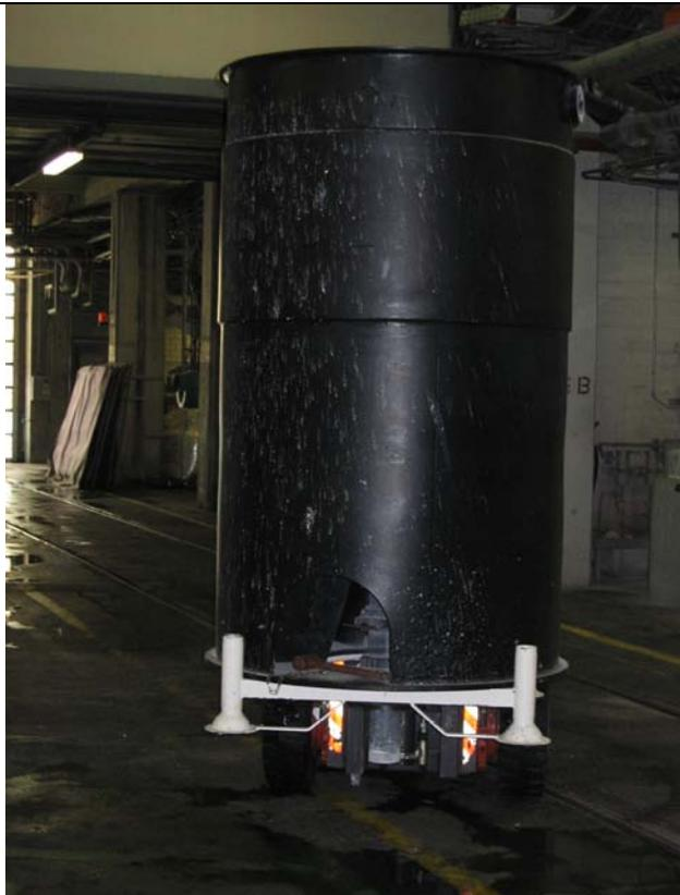
Umfüllvorrichtung mit Hammer zur Restentleerung
