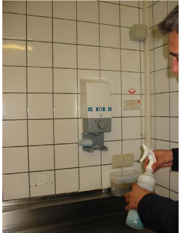
Zielgefäß ist Sprühflasche (zuerst wird Konzentrat dosiert, dann Wasser zugefügt)
