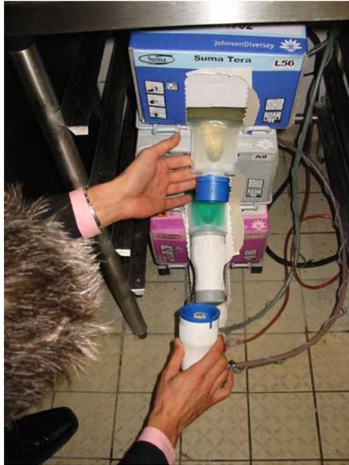
**Abb. 10.4** Steckvorrichtung an automatischen Dosierstationen
