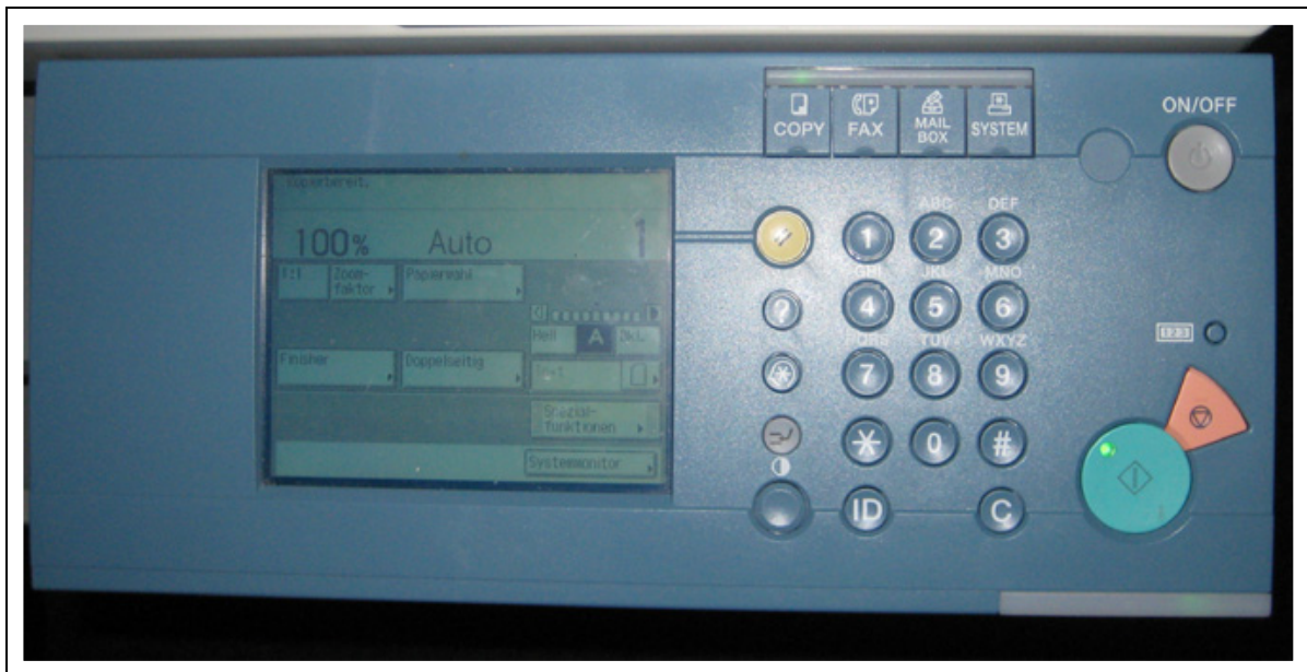
Abb. 4.23 Bedienoberfläche eines Kopierers mit Touchscreen
