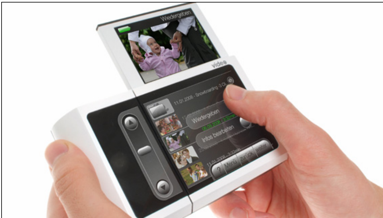
Abb. 5.28 Die dynamische Bedienung über den Touchscreen der Kamera zeigt in jedem Modus nur die Informationen, die benötigt werden.
