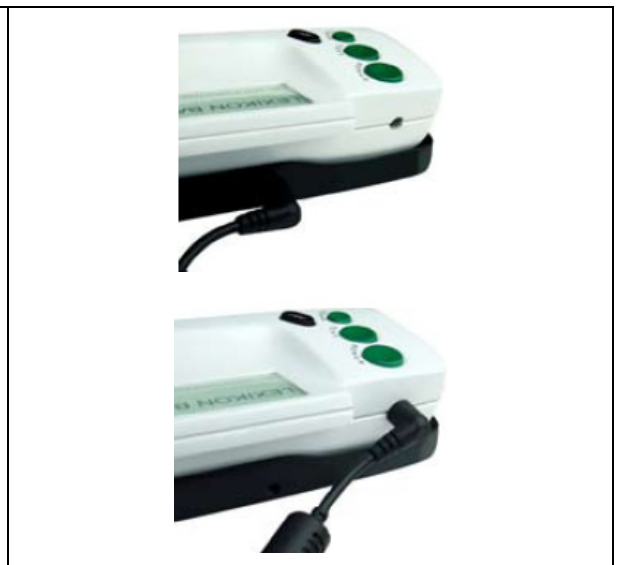
Abb. 5.14 Das Netzteil ist an der Ladestation oder am Printer anschließbar.
