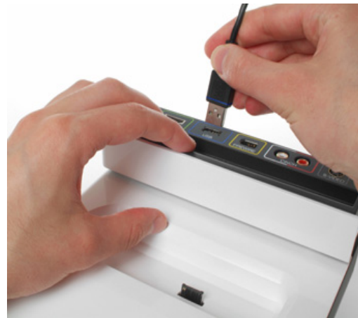
Abb. 5.27 Eine einfache Farbkodierung erleichtert das Anschließen
