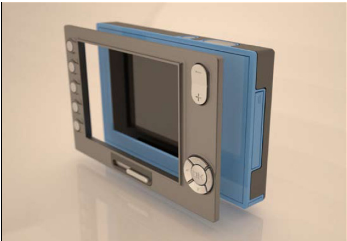
Abb. 5.29 MODCAM mit abnehmbarem Bedienfeld
