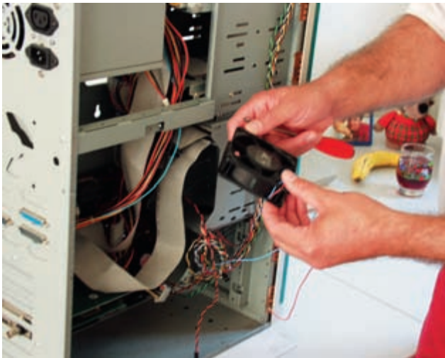
Bild 7 Einbau eines lärmarmen Lüfters in einen Arbeitsplatzcomputer
