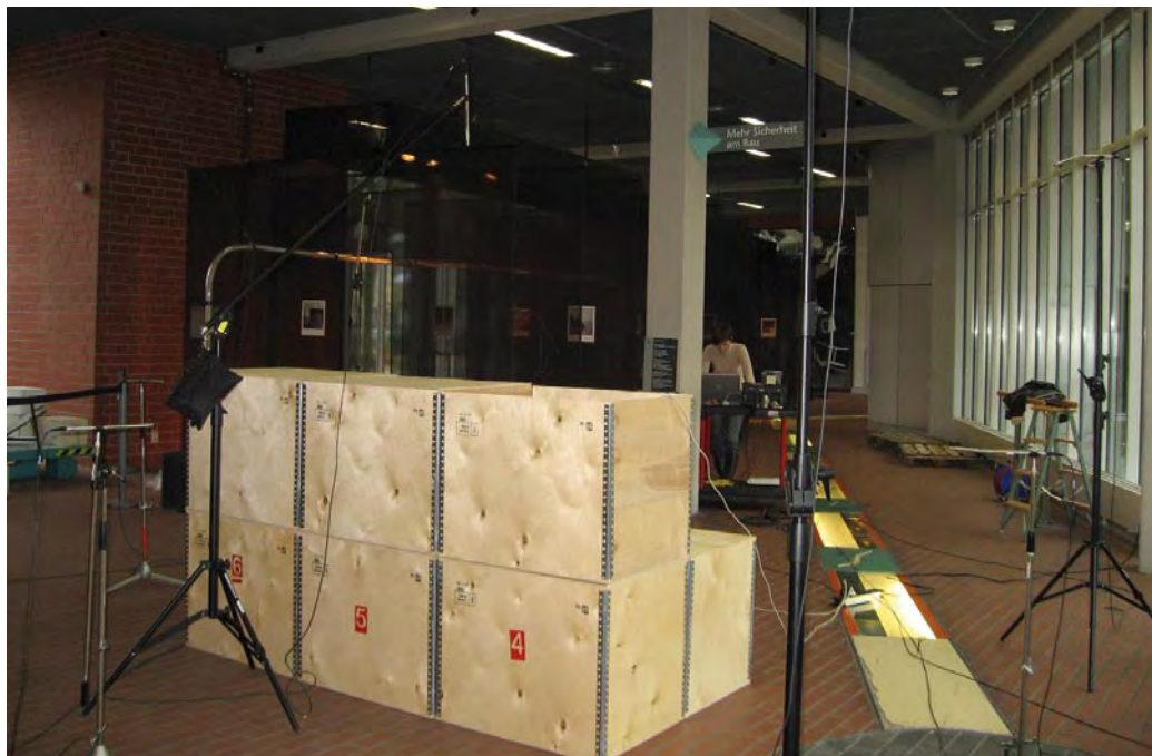
Verwendete Modellmaschine im Rahmen des Projektes zum Vergleich des in der entsprechenden Norm vorgeschlagenen Verfahrens zur Ermittlung der Umgebungskorrektur im Zusammenhang mit der Ermittlung des Schalleistungspegels von Maschinen in situ
