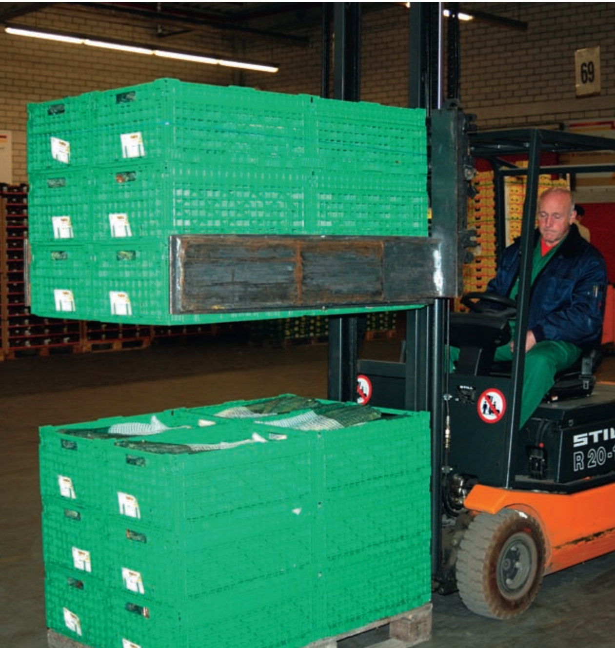
Abb. 6.9 Hebehilfen erleichtern die Arbeit im Obst- und Gemüselager (Bildquelle: REWE)
