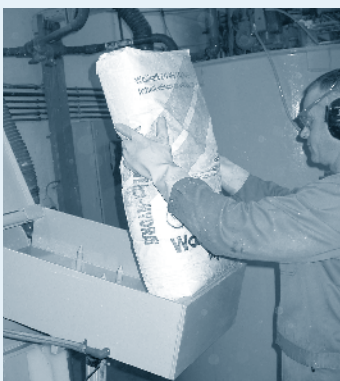
Schütte verringert Staubbelastung.
