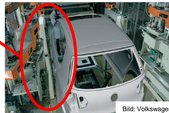
Bild: Volkswagen Kollisionsanalyse: Sicht entlang der Störkante
